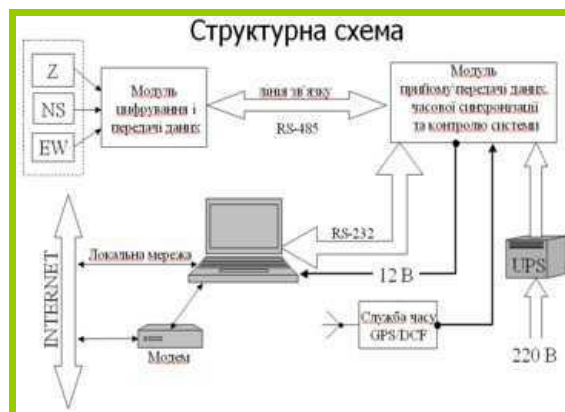
Рис. 2. Структурна схема сейсмічної станції «DAS-05»
